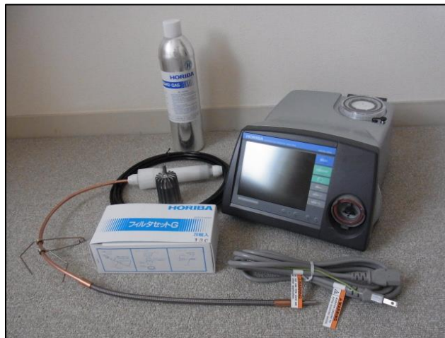
รูปที่ 5.4 เครื่องมือวัด HORIBA รุ่น MEXA - 584L
